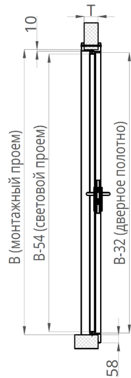
Рисунок 24. Разрез 4-4. Крепление рамы в обхват с порогом 60
