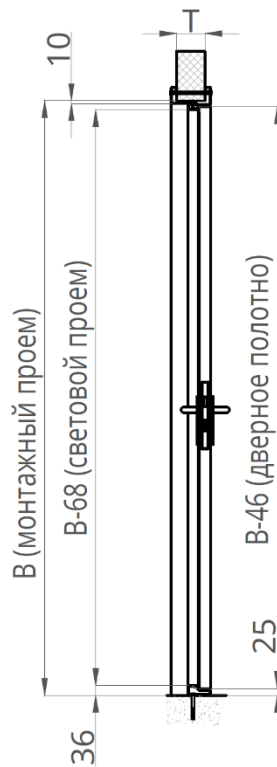
Рисунок 23. Разрез 3-3. Крепление рамы в обхват с порогом 40
