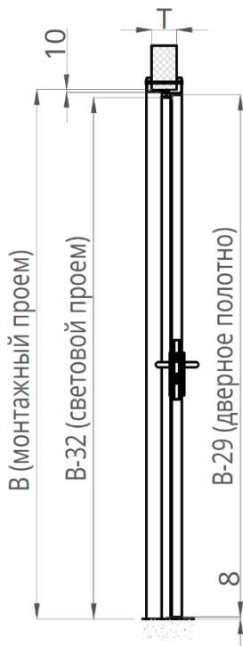
Рисунок 22. Разрез 2-2. Крепление рамы в обхват без порога
